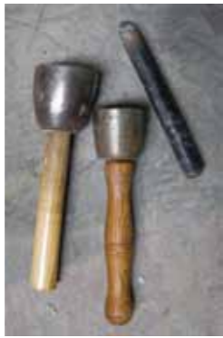
スペイン製のヘッドに野球の硬式バットを柄に利用した、敏さんオリジナルのハンマーと鑿。
